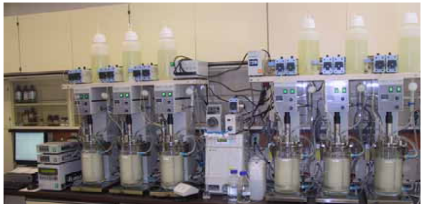
図1 モデル清酒もろみ発酵解析制御システム
