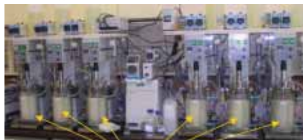
図2 清酒もろみの状態を解析するために開発した培養装置
