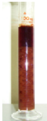
図2 排水と酵母の混合液(24時間処理後)の固液分離の様子(30分静置後)
